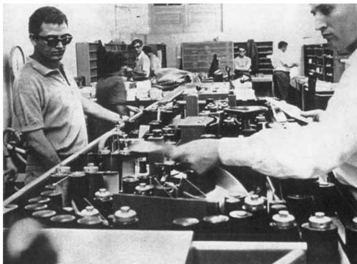
Altre immagini dell'impianto di Genova con la selva di cilindri e nastri per il posizionamento delle lettere
